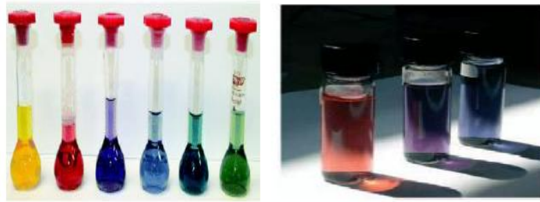
Figure I.3 : Changement de couleur de Solution contenant différentes fractions volumiques de nanoparticules d'Or, sous irradiation lumineuse [9]
