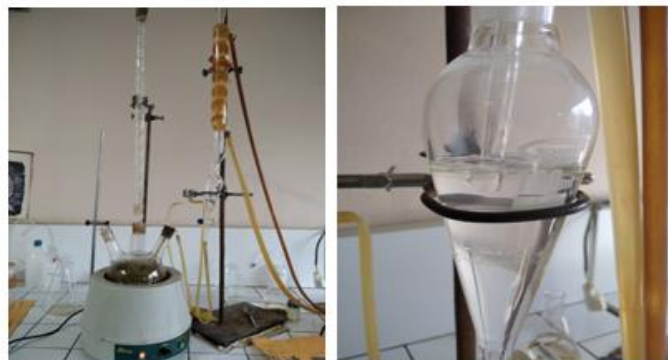
Figure 13 : Photo représentant l'appareil d'hydrodistillation de type Clevenger, utilisé dans ce travail
