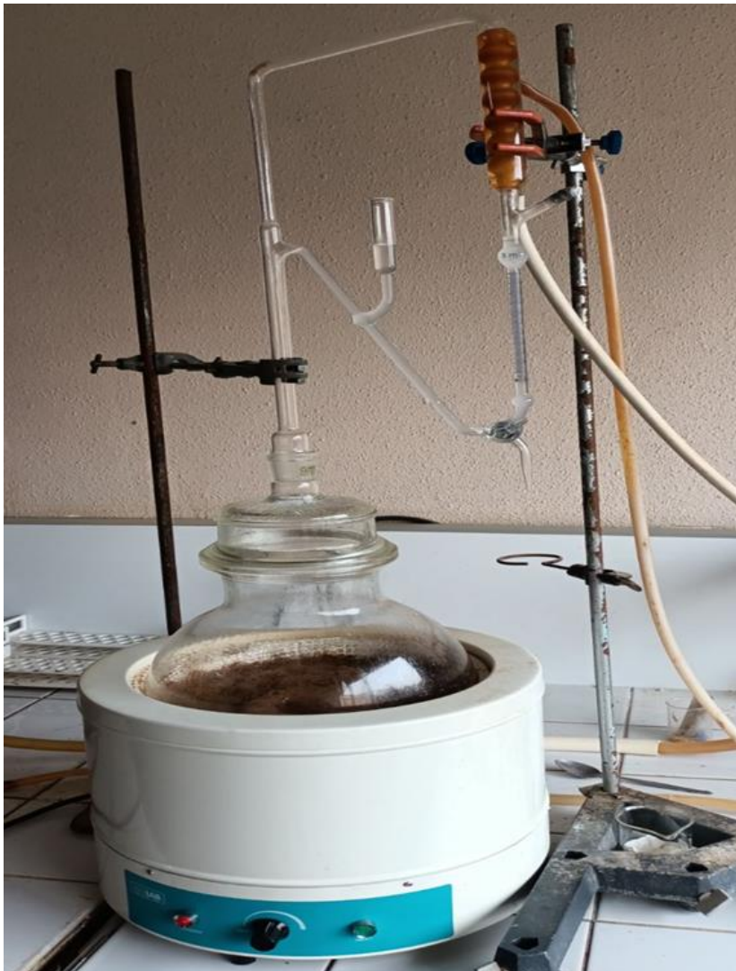
Figure 3 : L'extraction de Clou de Girofle ( Syzygium aromaticum ) dans un hydrodistillateur
