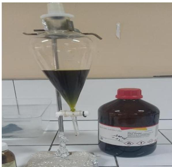
**Figure 14 :** Extraction liquide-liquide (Photo personnelle)
