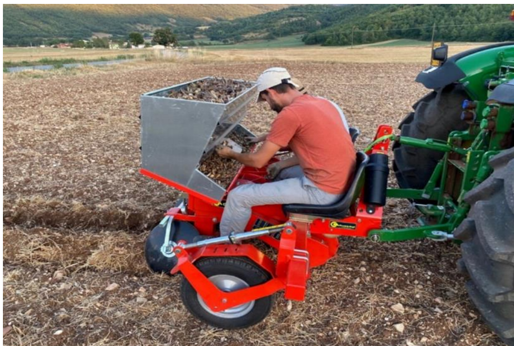
Figure 01 : Le tracteur et le semoir pour semi les bulbes sur ligne (chechi magli).
