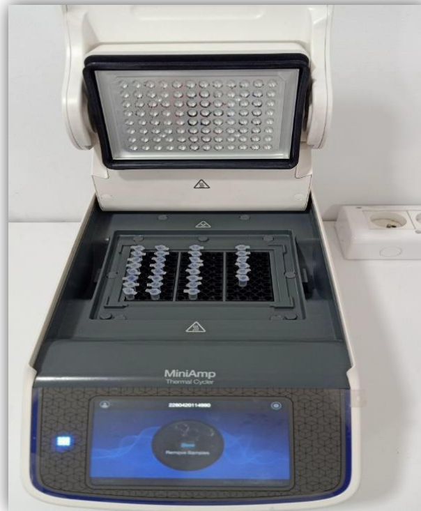
Figure 17: Représentation d'un thermocycleur PCR (MiniAmp Wiragen)
