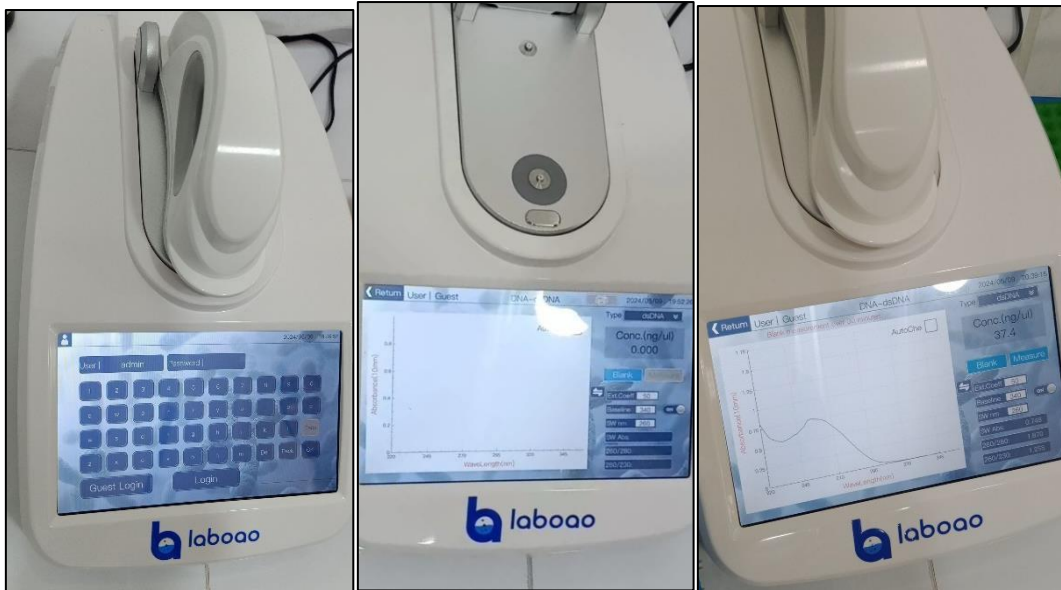
Figure 13: Représentation d'une spectrophométrie Nanodrop Laboao LND-100 (Wiragen)
