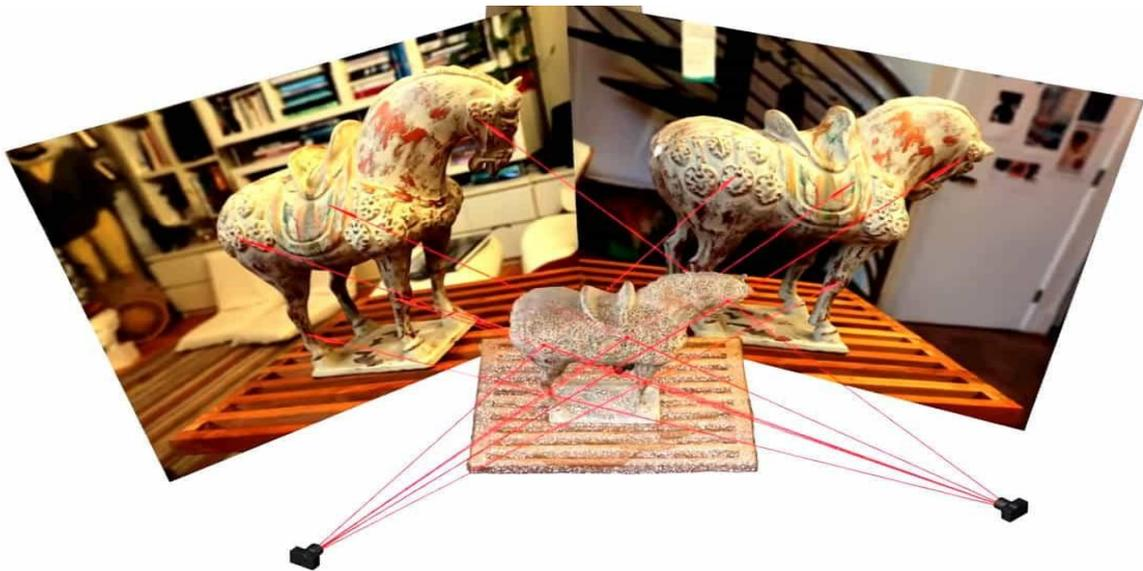
**Figure I.6** Image Modeler : Images source, points et Géométrie saisie manuellement avec rendu des couleurs.
