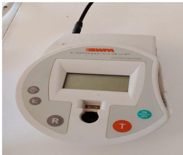
**Figure 22 :** le colorimètre mesuré la densité optique des bactéries et des levures
