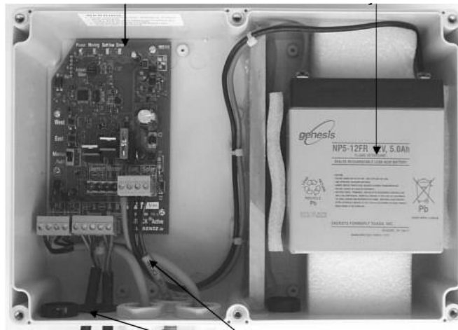
Figure 3.38 – Boîtier de contrôle Lorentz avec ses différentes connexions
