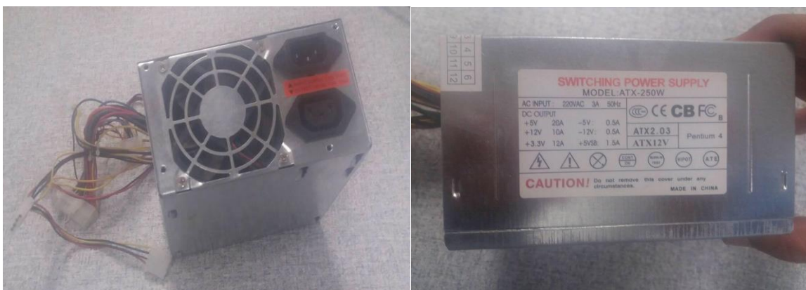
Figure 3.28 – (gauche) vue du boîtier d'alimentation, (droite) caractéristiques
