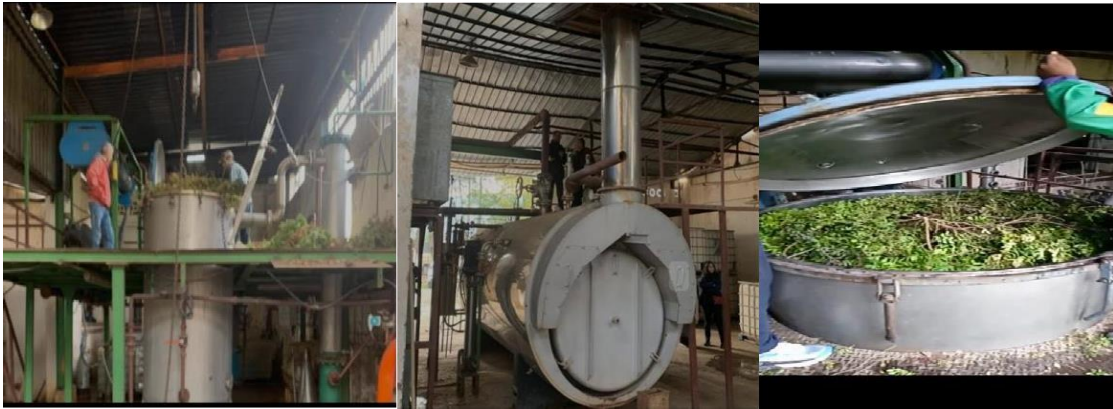
Figure05 : Entraînement à la vapeur d'eau des HE.
