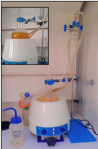
**Figure 37** : appareil CLEVANGER utilisé pour l'extraction d'huile essentielle
