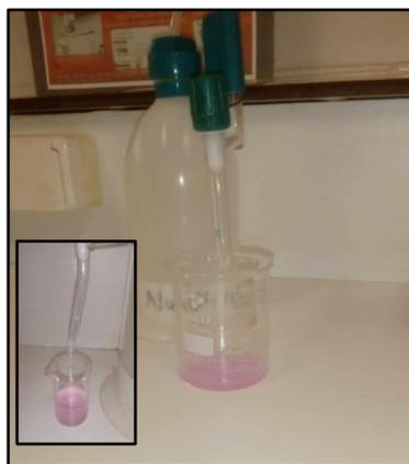
**Figure 39** : mesure de l'indice d'acide des huiles (photo originale)
