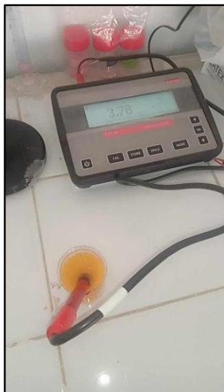
Figure 36 : détermination de l'acidité de jus d'orange douce par Ph mètre (Photo originale)
