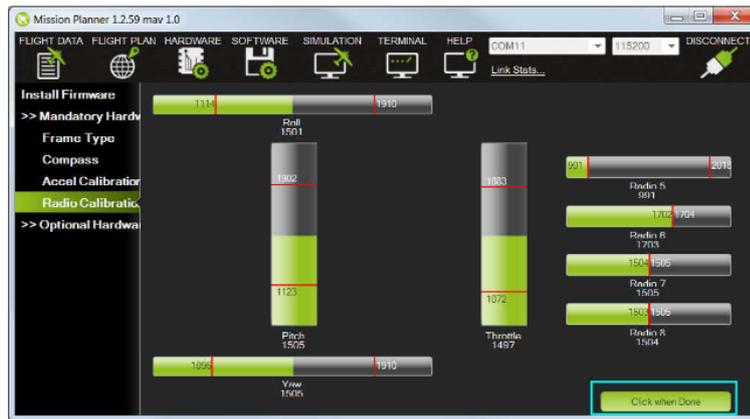
FIGURE 3.19 – Télécommande radio Calibration
