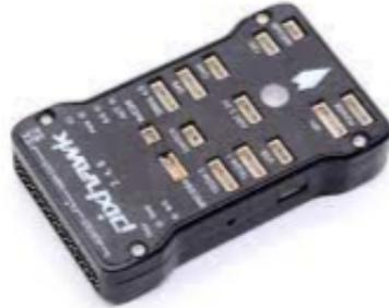
FIGURE 3.9 – Contrôleur De Vol (Pixhawk) [11].
