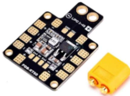
FIGURE 3.6 – Dual BEC 5V/12V PDB [9].
