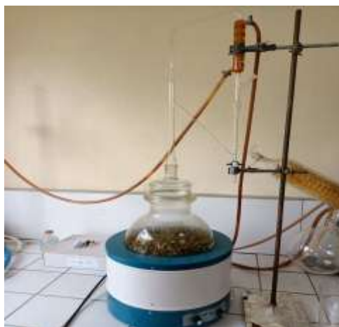
Figure 11 : Montage Clevenger pour l'extraction des huiles essentielles
