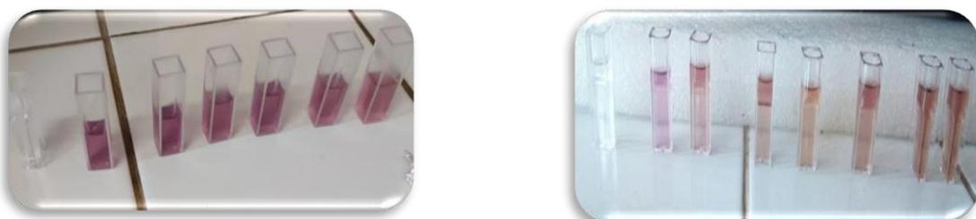
Figure II.21 : le mélange de 1ml de solution de DPPH +1ml d'antioxydant avant et Après incubation
