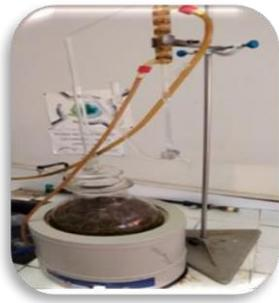
Figure II.7 : Appareil d'hydro distillation
