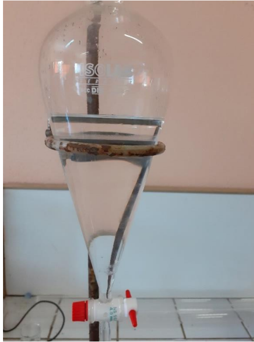
Figure 7 : Etape de décantation
