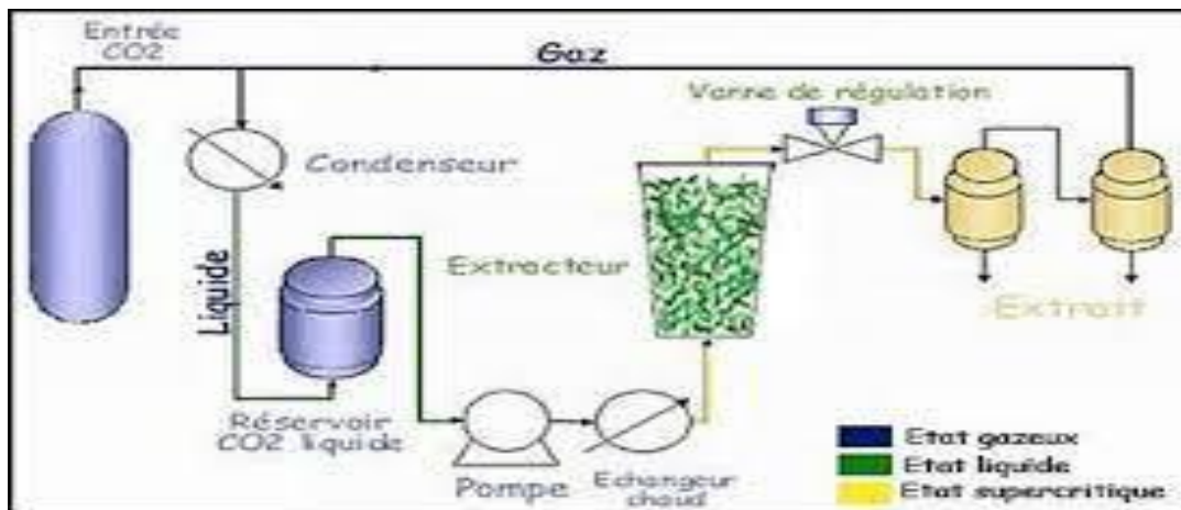
Figure 16 : Montage d'une extraction supercritique(52)
