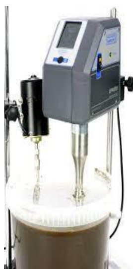
Figure 18 : Montage d'une extraction assistée par ultrasons(55)
