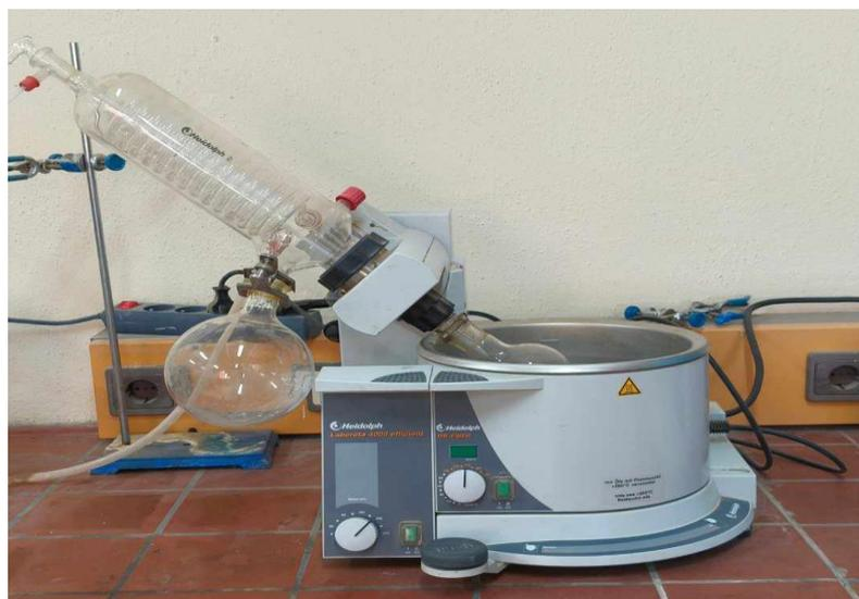
Figure 3.2 : L'évaporateur rotatif utilisé au niveau de labo d'ESST.
