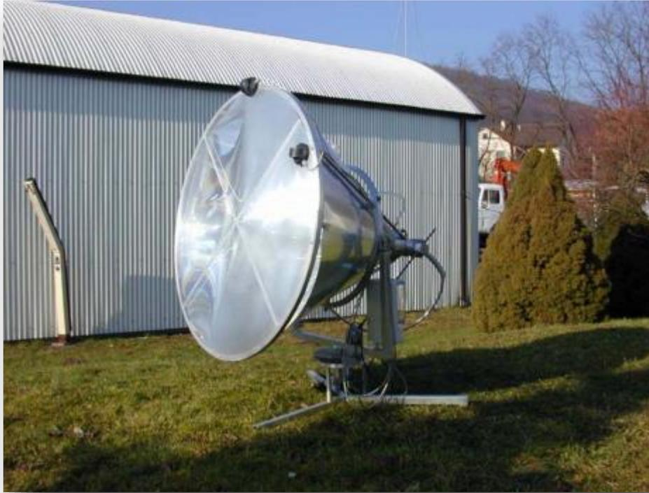
**Figure III-1** Un collecteur SOLUX sans le dôme de protection en acrylique [130].
