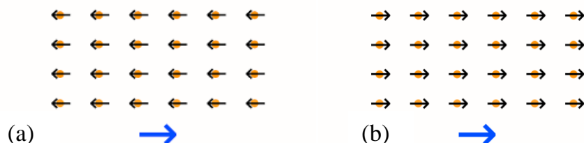
Figure 3 : Réaction de matériau diamagnétique (a) et paramagnétique (b) sous l'effet d'un champ extérieur.
