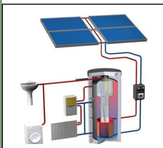
Figure 12 : détail technique d'installation système solaire
