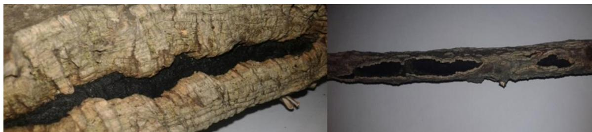
**Figure II.5. Croûte carbonacée apparaissant entre les fissures longitudinales du liège (photo originale)**
