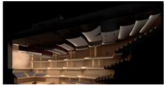
Figure 144:réflecteur acoustique en plastique ETFE
