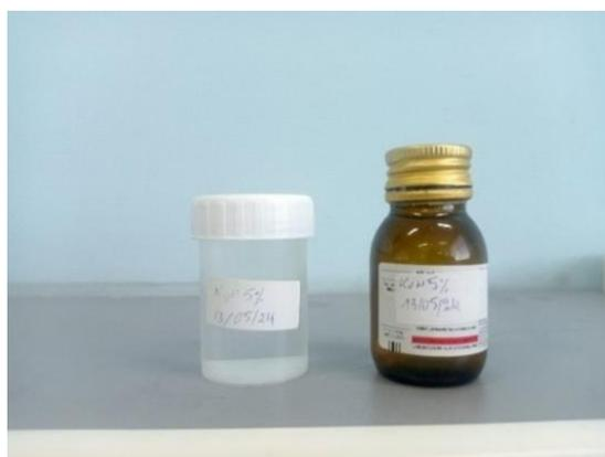
**Figure 27** : Solution de KOH en flacon ombré et en flacon en plastique.
