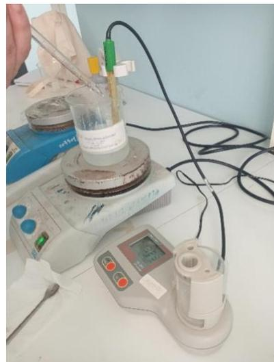
**Figure 10** : Contrôle du pH du mélange (blanc+ NaOH).
