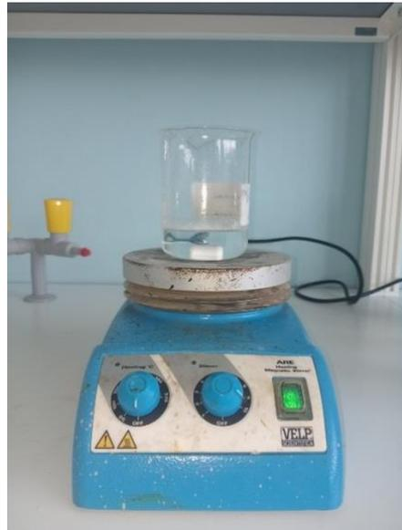
**Figure 9** : Mélange d'eau distillée et de carbopol sous agitateur magnétique.
