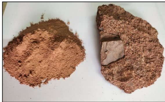
Figure 4 : photo de l'échantillon avant et après le tamisage.
