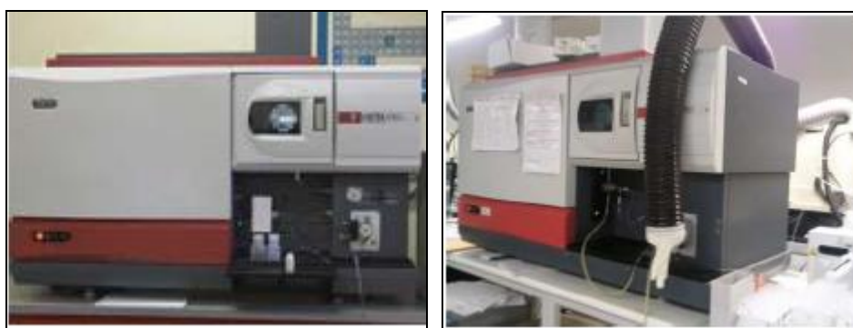
Figure II-11: Photographie de l'appareil d'ICP-AES.
