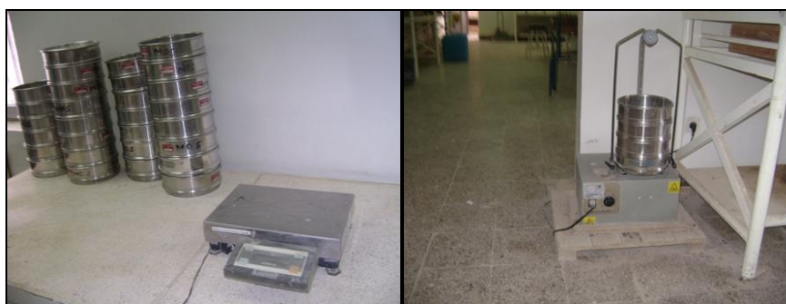
Figure II-5: Dispositif expérimental de la granulométrie par tamisage.
