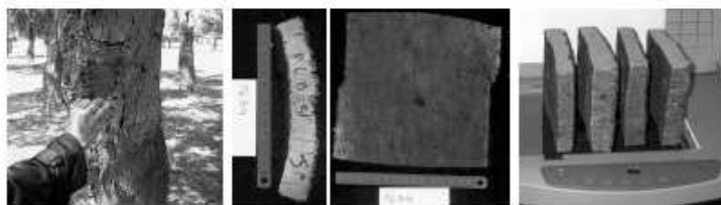
Fig. 3 : Etapas de l'étude de la qualité du liège par analyse d'image
