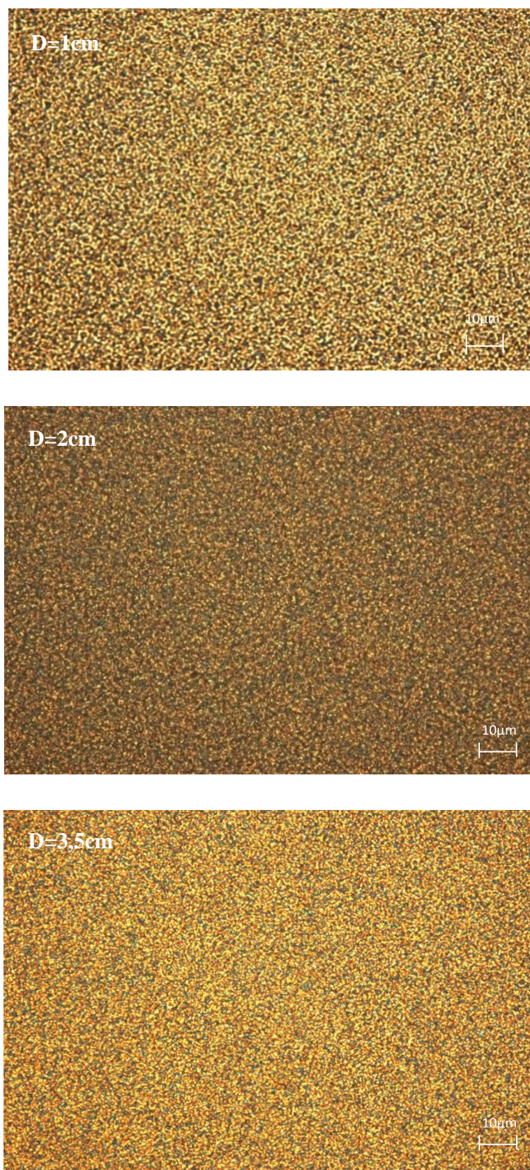
Figure IV.31 : Morphologie du système TPGDA/E7 (30/70%) irradié durant 60,06s par la lumière UV pour trois distances D
