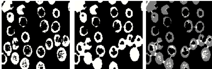
Figure II.18 – Exemple de fermeture binaire (de gauche à droite : image initiale, fermeture par un disque de taille 3, différence : en blanc, les parties rajoutées par la fermeture).
