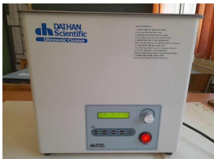
Figure 20. Bain à ultrason WUC-D10H
