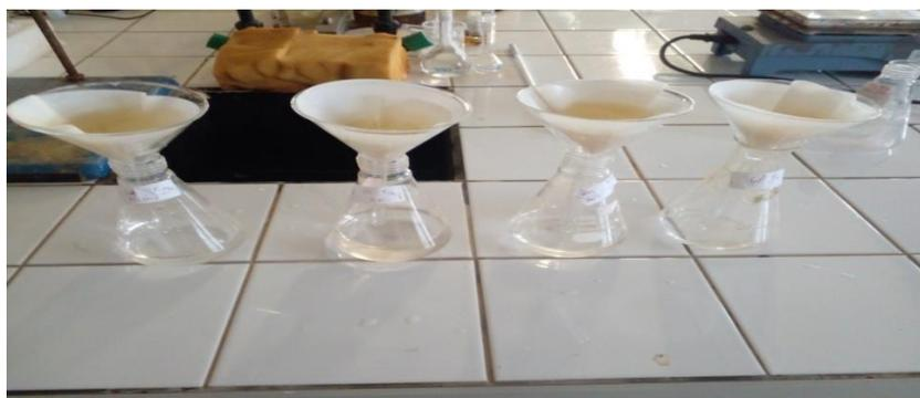
**Figure N°02** : L'étape de la filtration de la bentonite saturée.
