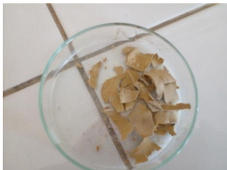
**Figure N°03** : La bentonite séchée après la saturation
