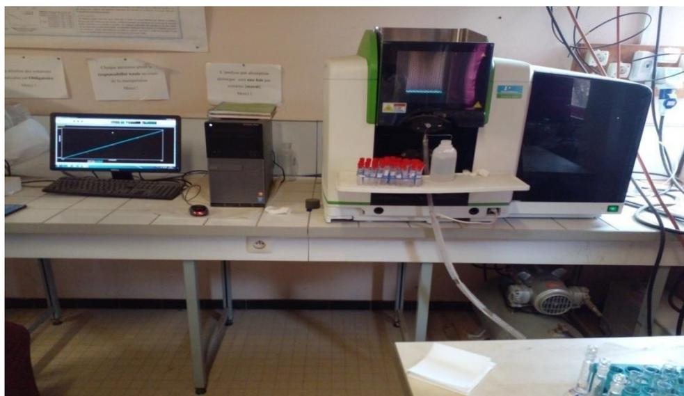
**Figure N°05** : Spectroscopie d'absorption atomique.
