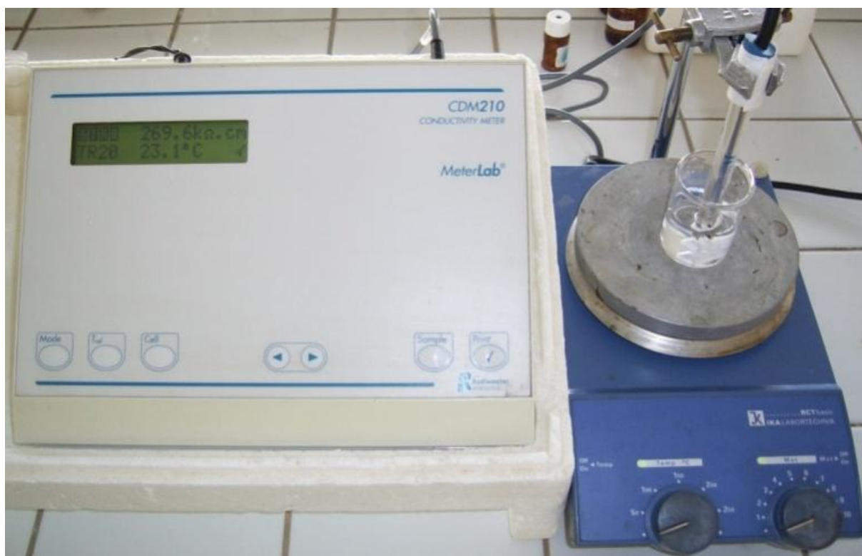
Figure 8 : Conductimètre utilisé avec sa cellule conductimétrique
