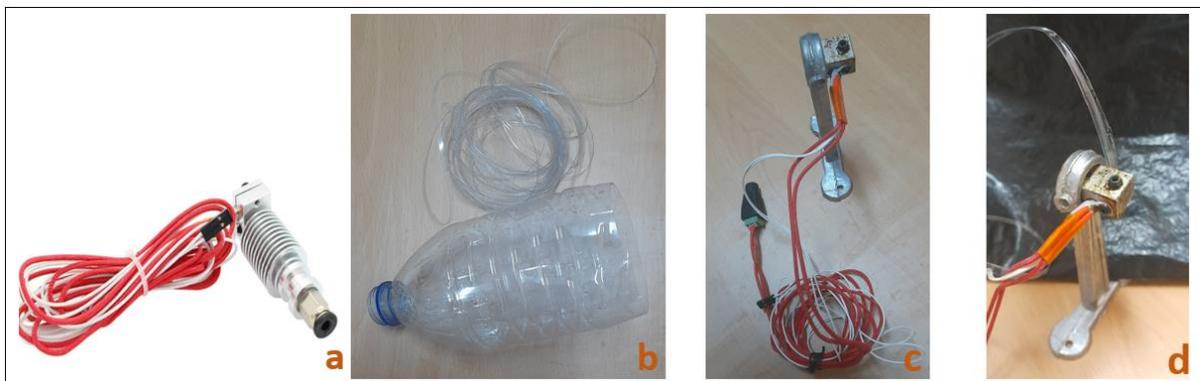
**Figure I-1**: a) résistance électrique avec tête d'extrusion, b) bouteille en PET coupée, c) Prototype d'extrudeur conçu, d) Processus d'extrusion.
