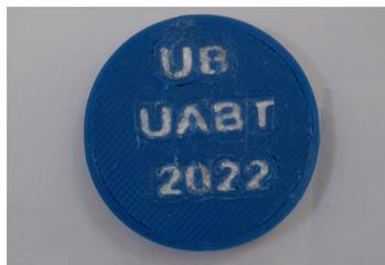
*Figure II-3: Pièce imprimée avec le filament en PLA (bleu) + PIBoMA(bleu)*
