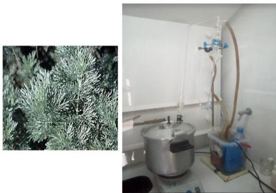
*Figure II-2 : Dispositif d'hydrodistillation<sup>34</sup> LCSCO*
