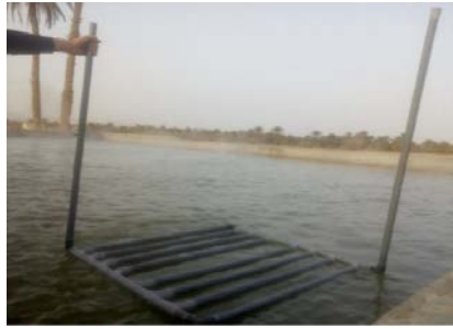
Figure I. 15 : Echangeur à 8 tubes Expérience de chauffage.
