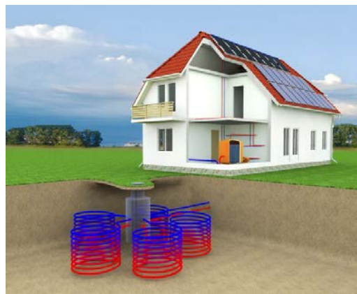
Figure II. 22. Schéma expliquant le principe de fonctionnement d'une corbeille géothermique. [40]
