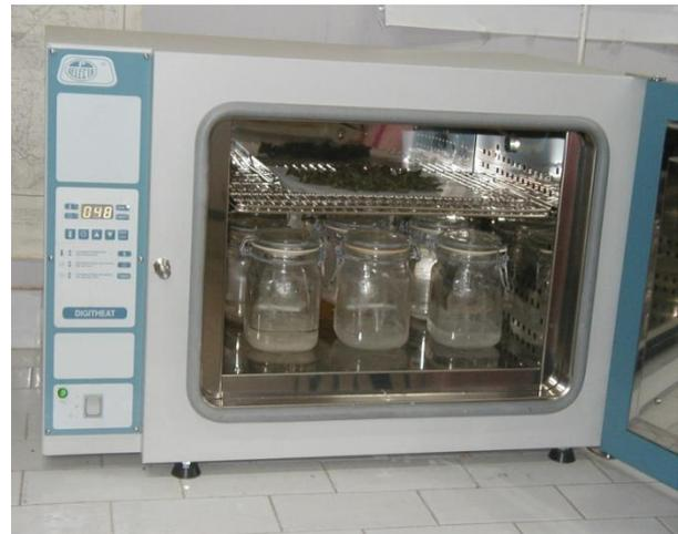
Figure (II.1) : Dispositif expérimental pour la mesure des isothermes de sorption
