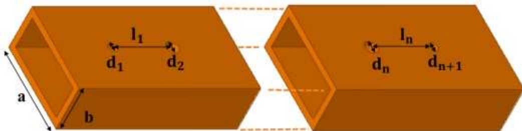
Figure III.6. Différentes dimensions d'un guide d'onde a post inductif
