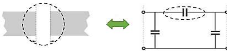
Figure III.10. La création d'une capacité série en ligne micro ruban
