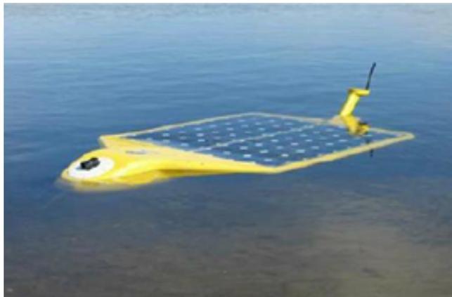
FIGURE 1.17 – Sous-marin AUV (AUSI)
