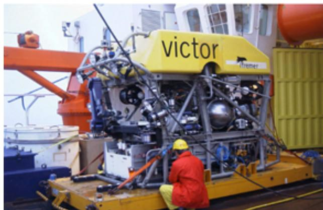
FIGURE 1.9 – Sous-marin ROV [10]
