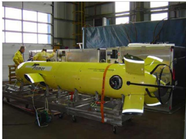
FIGURE 1.11 – Sous-marin AUV [10]
