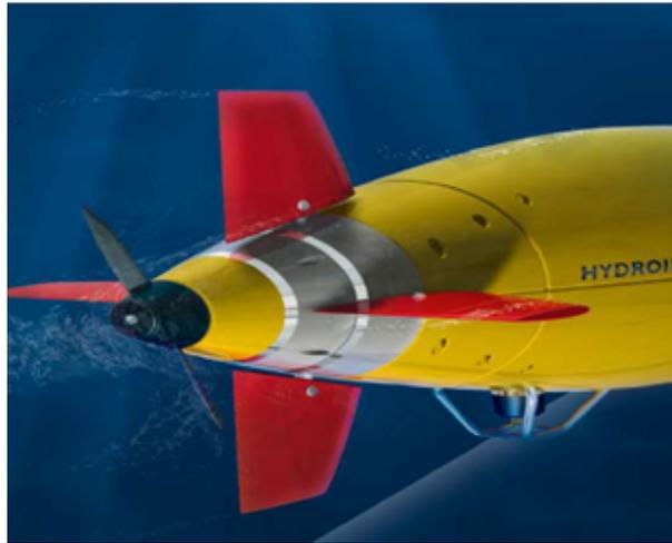
FIGURE 1.20 – Gouvernails ou Surfaces mobiles de l’AUV [17]
