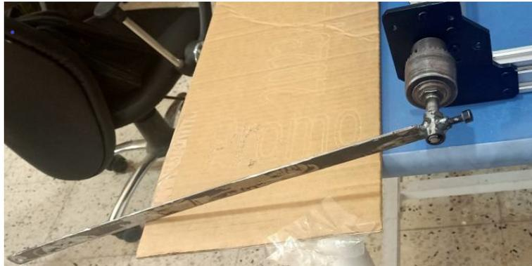
FIGURE III.5 – Tige en metal pour détermination du couple de système.
