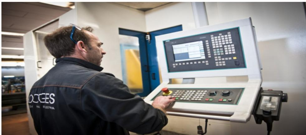
FIGURE I.1 – Exemple de pupitre d'une machine à Commande Numérique. [16]
