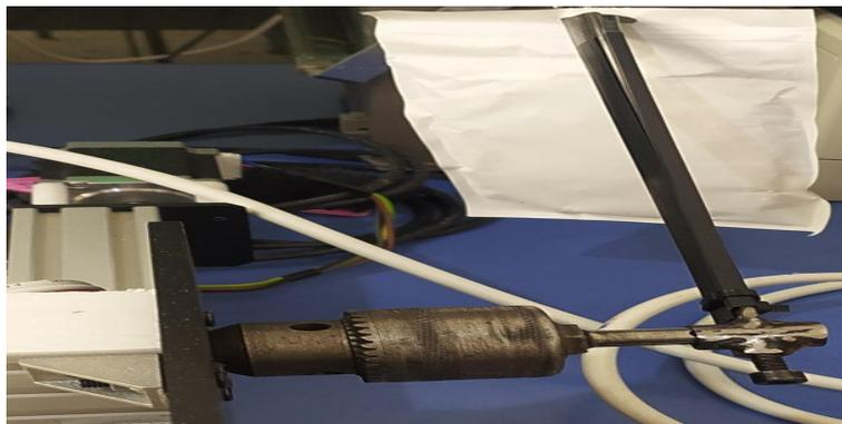
FIGURE III.6 – Tige avec masse négligeable pour la détermination du couple du système.
