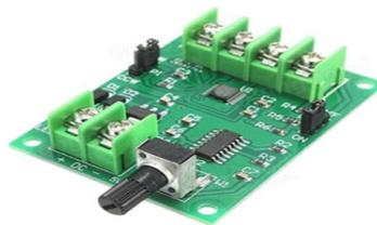
FIGURE I.7 – Carte de pilotage du moteur de perforation. [3]
