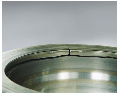
Figure II.10 : Fissure de la bague extérieure d'un roulement
