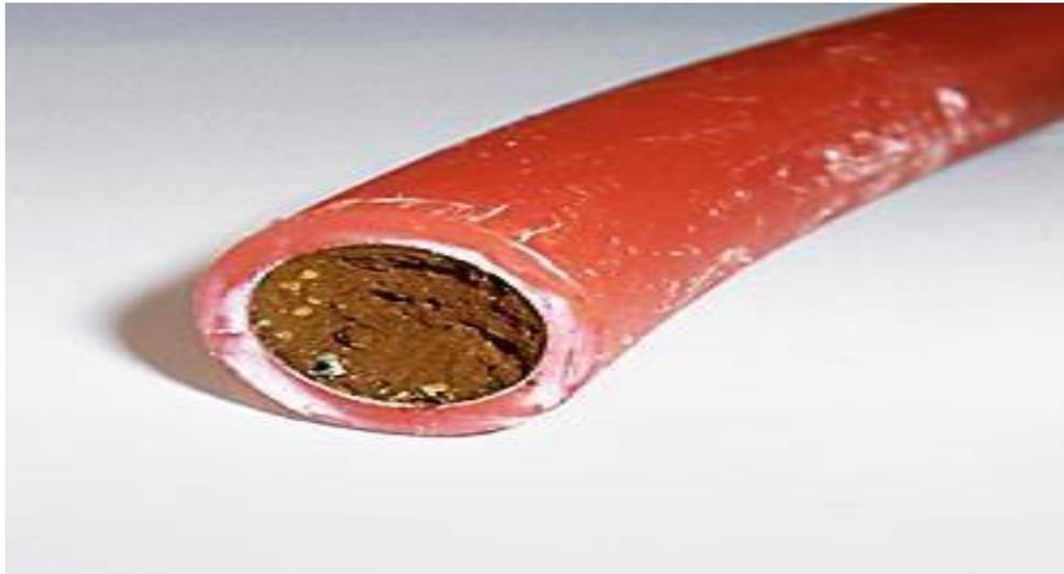
**Figure (2.7) :** formation de boue dans un tube en Polyéthylène
