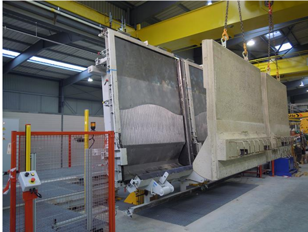
Figure 15 : Image d'un moule pour la fabrication de panneaux de béton préfabriqués
