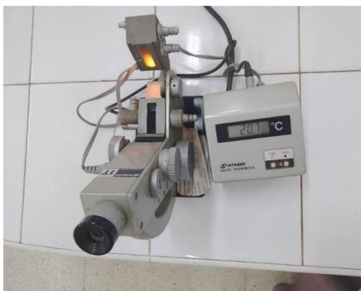
Figure 10: Réfractomètre
