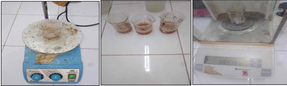
Figure 6: Détermination de l'acidité.
