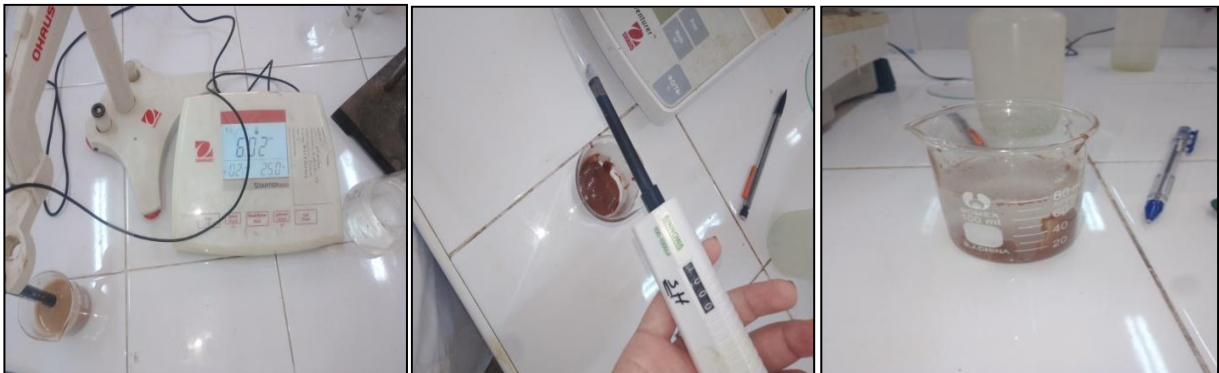
Figure 2: Détermination du potentiel d'hydrogène (pH).
