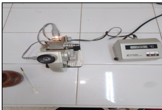
Figure 3: Détermination de l'indice de réfraction et le degré Brix.
