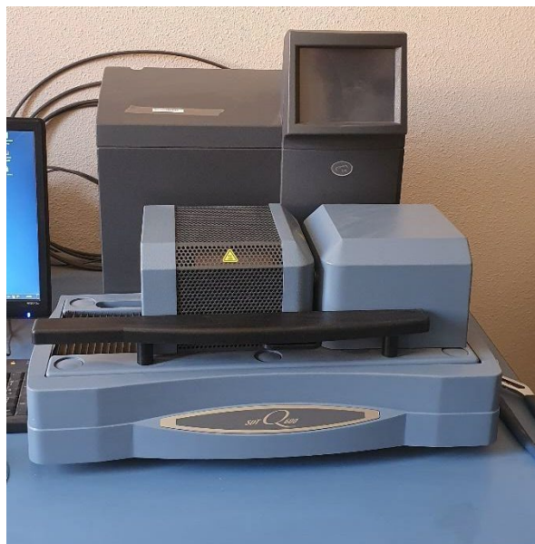
Figure II.7. SDT Q 600 TGA (LAEPO).
