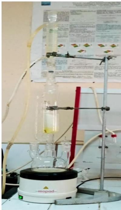
**Figure 15** : Montage d'un extracteur soxhlet
