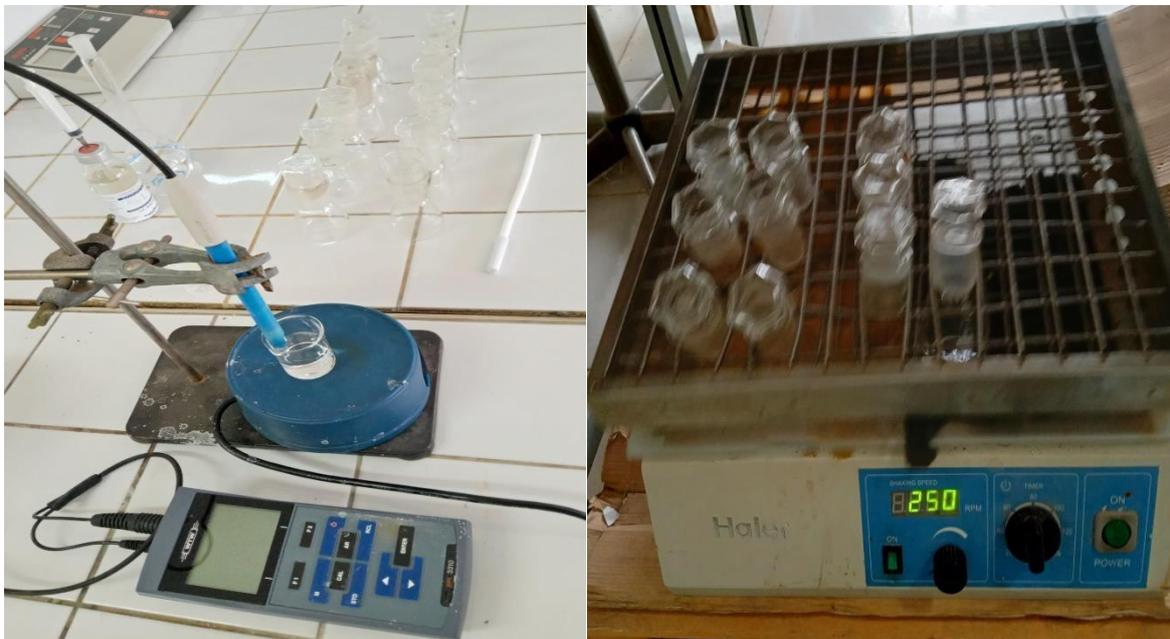
**Figure 16 :** Préparation du point de charge nulle sur agitateur mécanique (HAIER)
