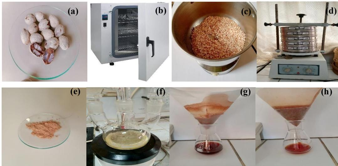
**Figure 13** : étapes de préparation du biosorbant (a) lavage des noyaux de *chamaerops humilis*, (b) séchage, (c) broyage, (d) tamisage, (e) poudre fine de 200 $\mu$ m, (f) dégraissage, (g) lavage par l'éthanol, (h) lavage par l'eau distillée
