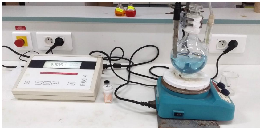
Figure 7: Montage de synthèse des matériaux HDLs par coprécipitation
