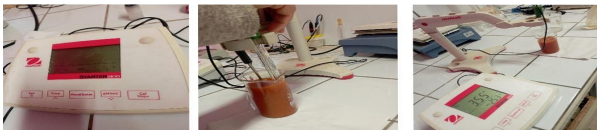
Figure 14 : Méthode de mesure du pH.
