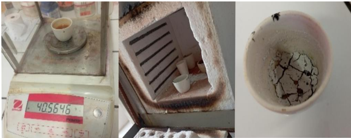
Figure 18 : Méthode de détermination de la teneur en cendres.
