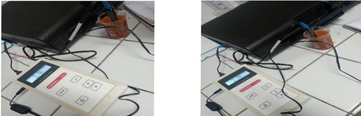
Figure 15 : Méthode de mesure de la conductivité électrique (conductimètre).
