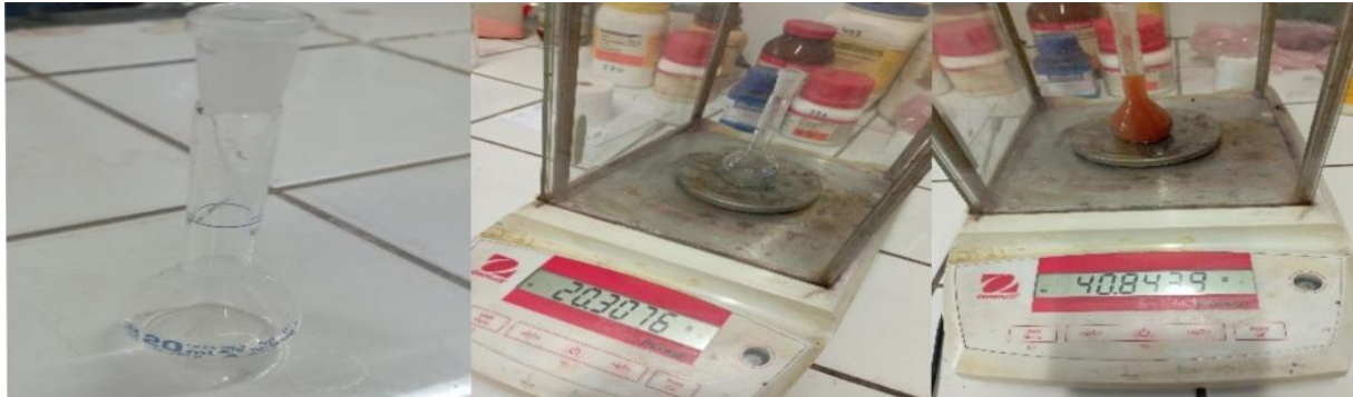
Figure 13 : Méthode de mesure de la masse volumique.
