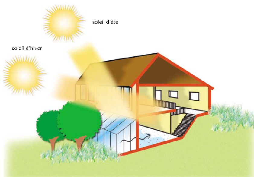
Figure 3 : Angle solaire en été et en hiver pour une façade sud [ADEME]
