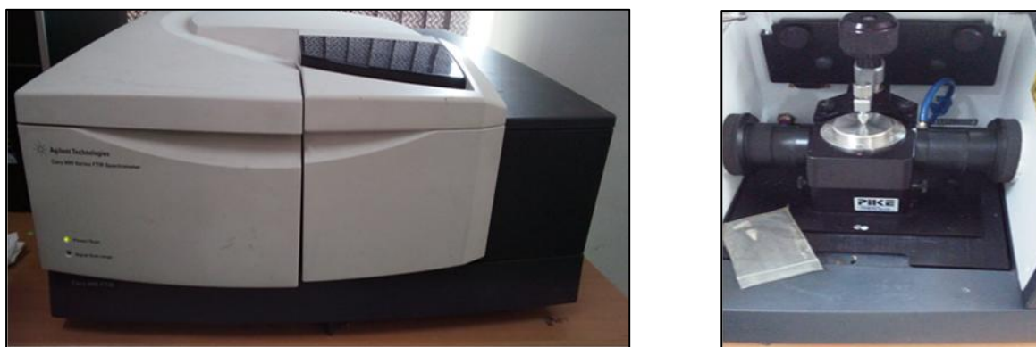
Figure 14 : Appareil FTIR utilisé pour la caractérisation
