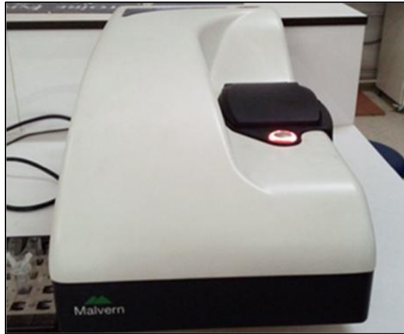
Figure 16: Appareil Zetasizer utilisé pour la caractérisation
