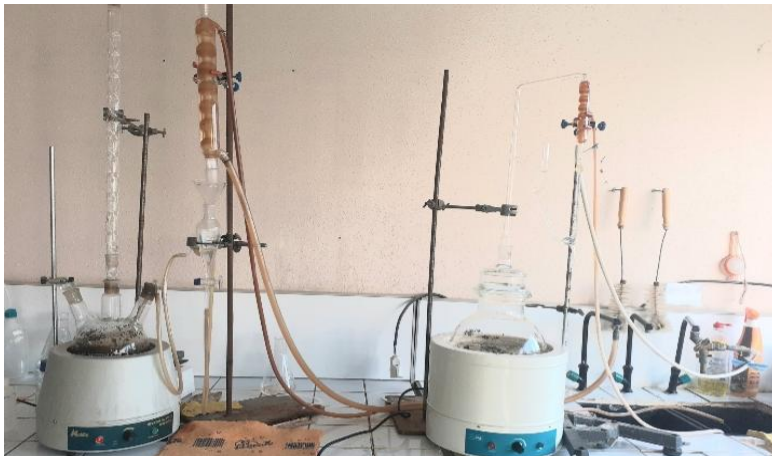
Figure 8 : Photo représentant l'appareil d'hydrodistillation de type Clevenger, utilisé dans ce travail
