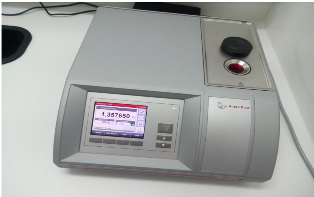
Figure n° 51: la détermination de Taux de sucre dans le fruit par le réfractomètre (Originale)
