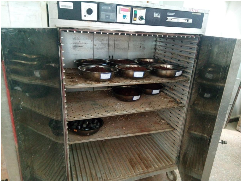
Figure n° 56: séchage des échantillons dans une étuve (Originale)
