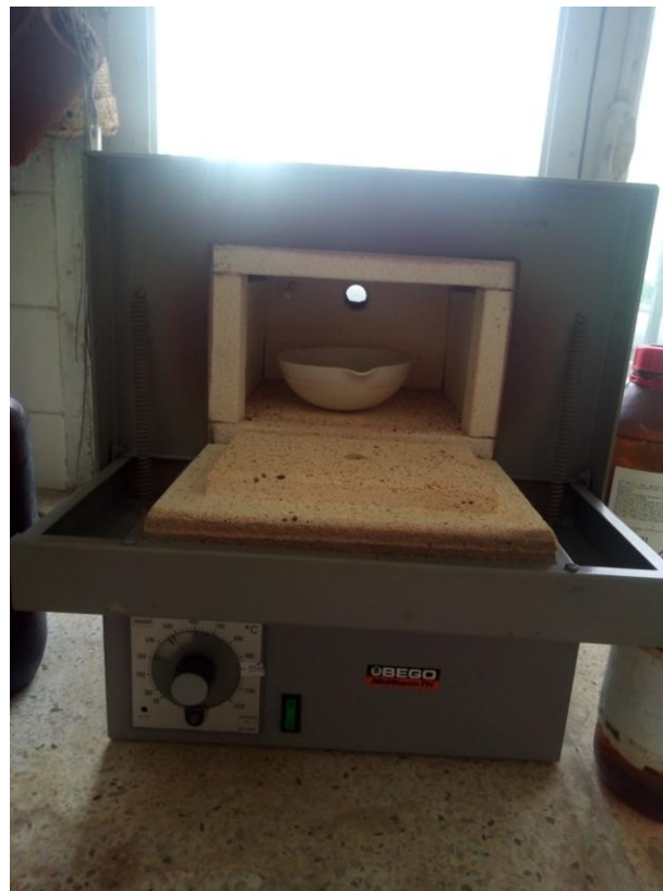
Figure n° 59: l'emplacement d'un échantillon du sol dans un four a moufle (Originale)
