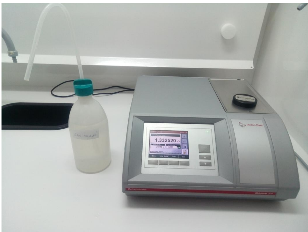
Figure n°48 : l'étalonnage de l'appareil par l'eau distillée (Originale)
