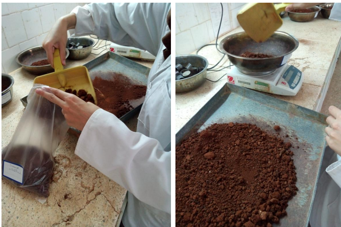
Figure n°53 : la préparation et pesage des échantillons (Originale)
