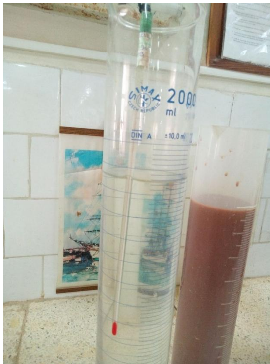
Photo de l'utilisation d'un thermomètre pour le mesurage de la température du sol
