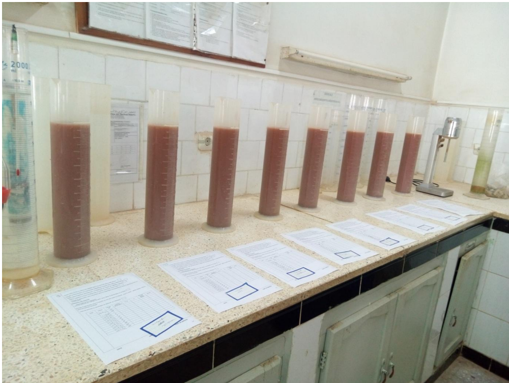
Figure n° 58: test de la sédimentation des particules du sol (Originale)
